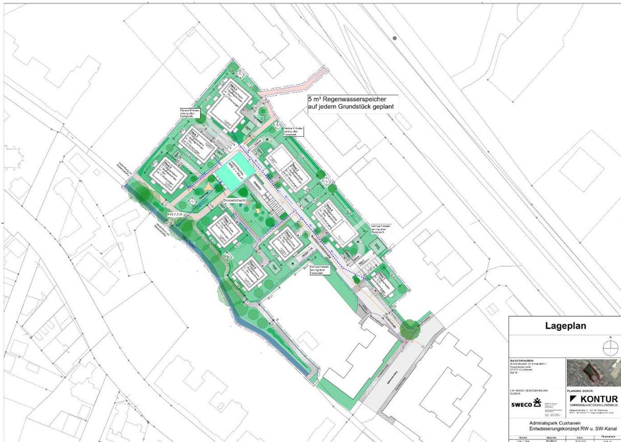
Abbildung 10: Entwässerungskonzept Sweco, auch als Anlage beigefügt
