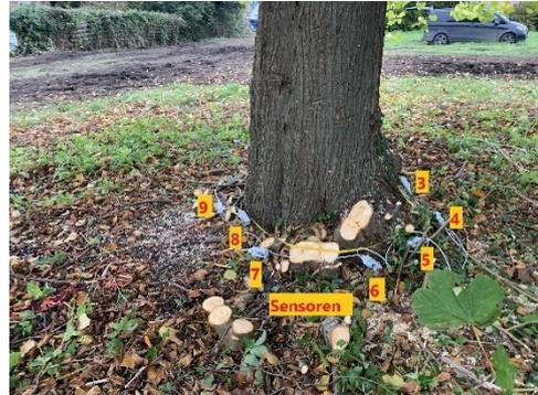
Abb.: 5-51 Positionierung der Sensoren 3-9
