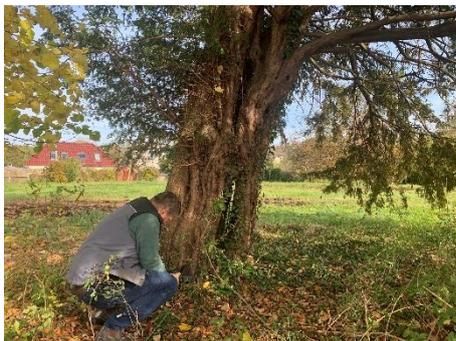
Um das Ergebnis der Schalltomographie zu bestätigen wurden 7 Bohrwiderstandsmessungen durchgeführt.
