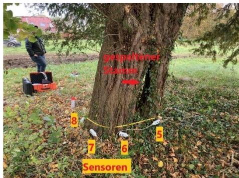
Abb.: 5-19 Positionierung der Sensoren 5 - 8
