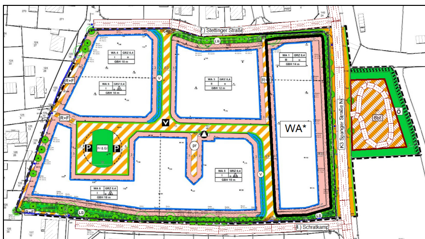
Abbildung 3 Kennzeichnung der Fläche, für Schallschutzmaßnahmen vorzusehen sind
